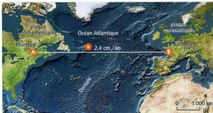
1.a Déplacement mesuré par GPS entre deux stations de part et d'autre de la dorsale océanique dans l'océan Atlantique
