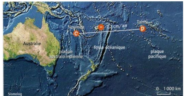
1.b Déplacement mesuré par GPS entre deux stations de part et d'autre d'une fosse océanique dans l'océan Pacifique
