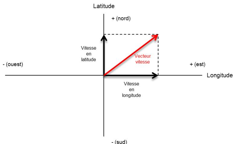
Pour obtenir le déplacement global de la station, on détermine graphiquement ou mathématiquement la norme du vecteur vitesse de déplacement à partir de ses composantes en longitude et en latitude, en  $\text{cm.an}^{-1}$ .
